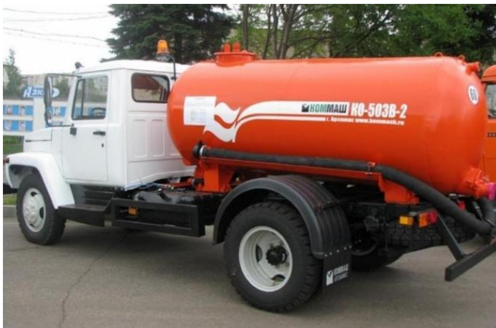
Рисунок 32 – Вакуумная машина КО-503В-2 на шасси ГАЗ-3309
