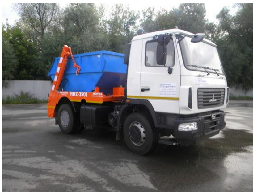
Рисунок 24 - Бункеровоз МКС-3501 на шасси МА3-5551А2
