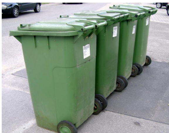
Рисунок 5 - Стандартные контейнеры типа К-0,75 с доработанной крышкой.
