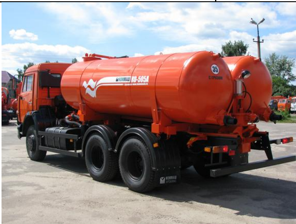
Рисунок 33 - Вакуумная машина КО-505А на шасси КамАЗ-65115-71
